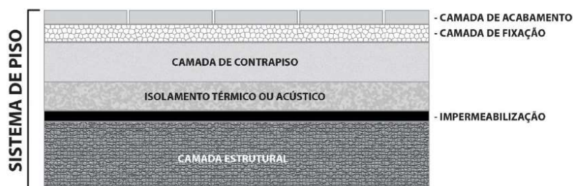
Figura 22 – Exemplo genérico de um sistema de pisos e seus elementos.
