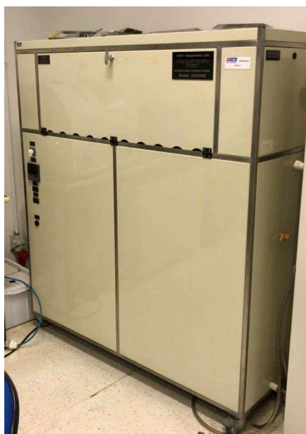
Figura 13 – Câmara de degradação utilizada no estudo de propriedade do Senai Cimatec.
