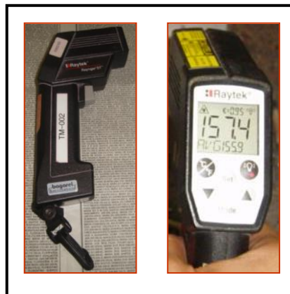
Figura 3.5 – Pirômetro usado para o controle de temperatura de pré-aquecimento.
