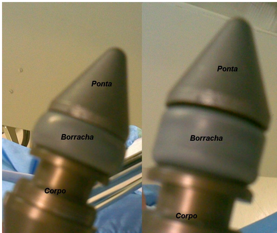
Figura 11: i) Chuck desacionado – Figura à esquerda, ii) Chuck acionado – Figura à direita
