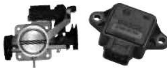
Figura 12: Corpo da borboleta e sensor borboleta, respectivamente.
