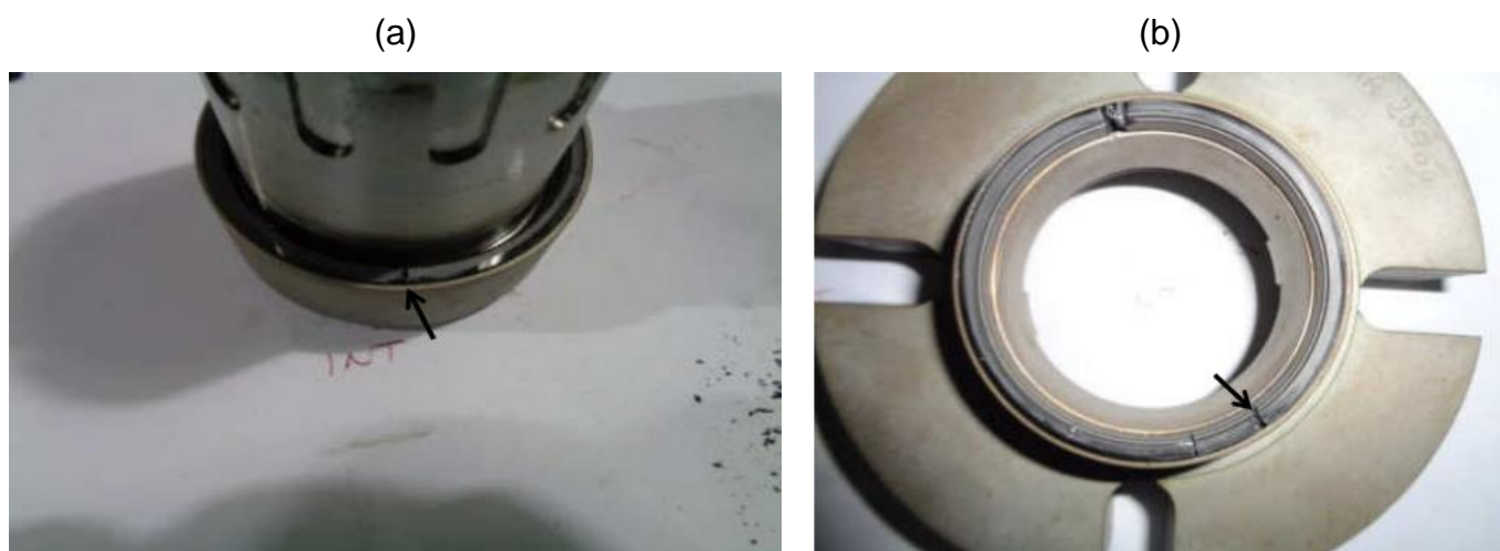
Figura 3 – Face da Sede e Anel de vedação interno quebrada. Faces com aspecto fosco demonstrando deficiência de lubrificação.
