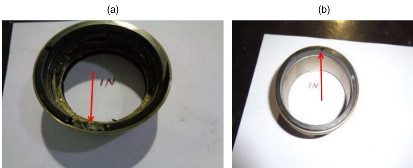
Figura 5 – Face da Sede interna danificada. Sujeira e anel primário com face riscada.
