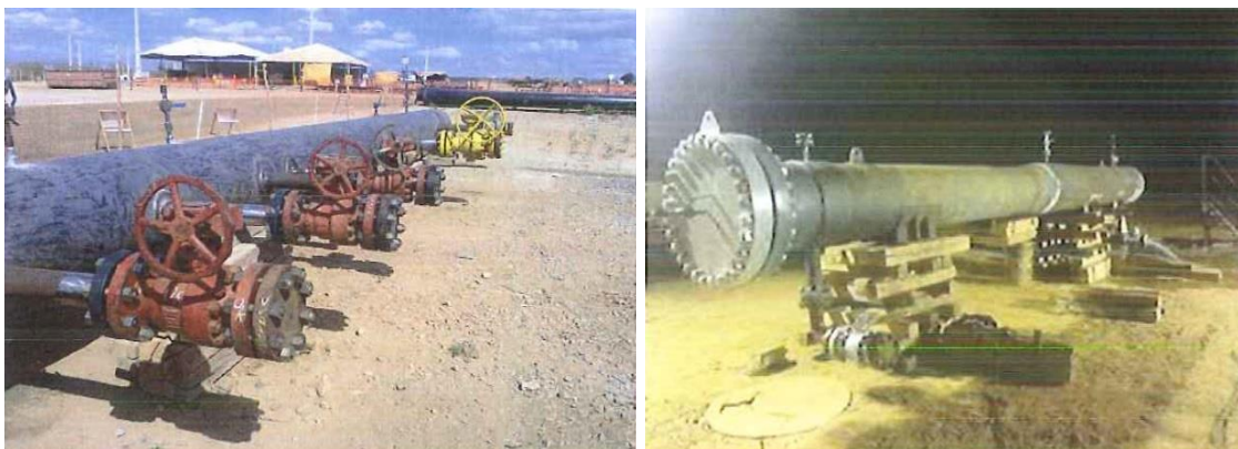
Figura 2. Teste hidrostático nos LP/RP: Lançadores de 26 pol. e 18 pol.
