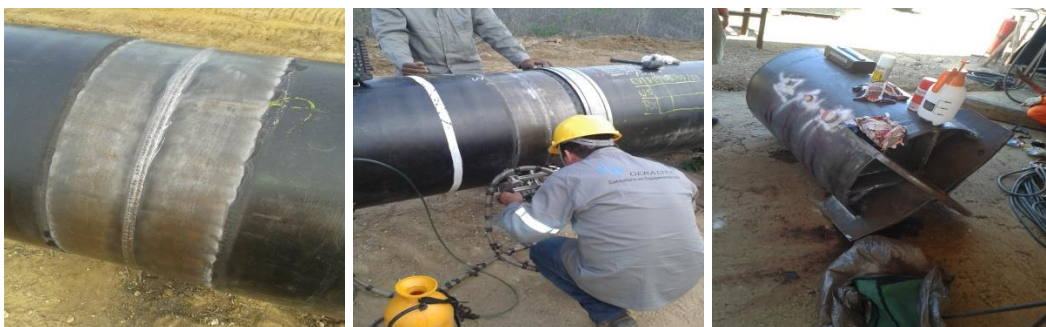
Figura 1 - Ensaios visual de solda, ultrassom automatizado e líquido penetrante.
