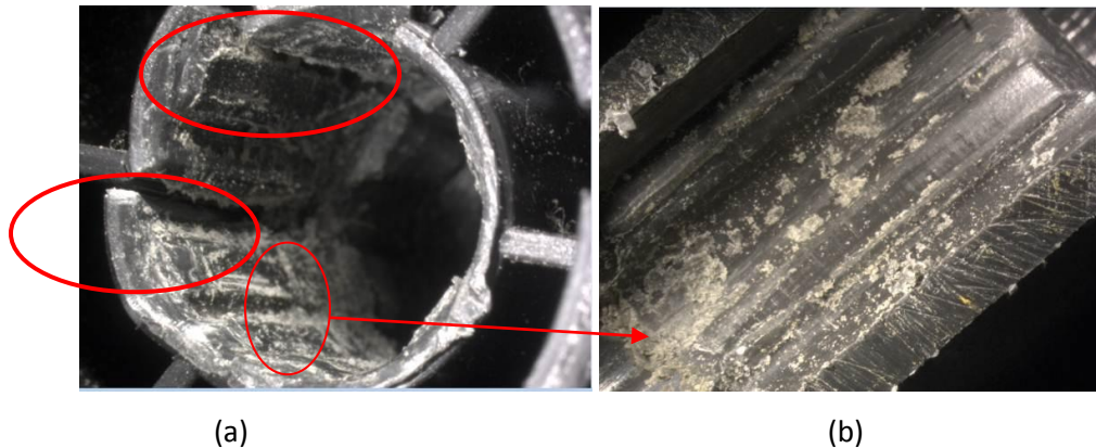
Figura 2 - Fotoestereoscopia da área de ruptura vista por cima (a) e da região de desgaste com pontos de fadiga e fragilização (b) com magnitude de 6,4X
