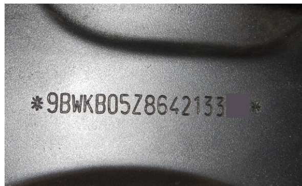
Figura 20 – Sobreposição por chapa metálica. O aspecto final é muito próximo ao da gravação original. Fonte: Autor.
