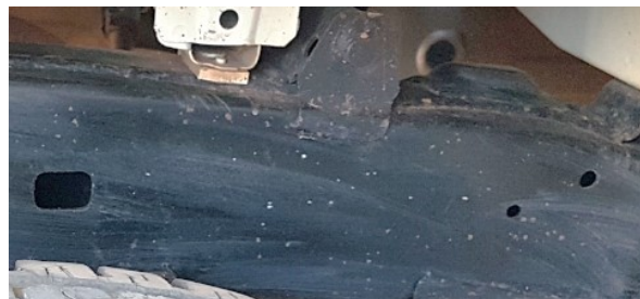
Figura 23 – Recobrimento da peça suporte com massa plástica e pintura para regravação em local distinto – resultado final. Fonte: Autor.
