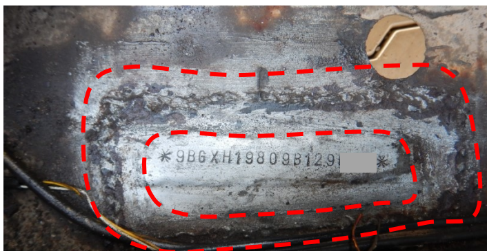
Figura 21 – Substituição parcial da peça suporte. A área entre as linhas tracejadas indica degradação na região do cordão de solda. Fonte: Autor.
