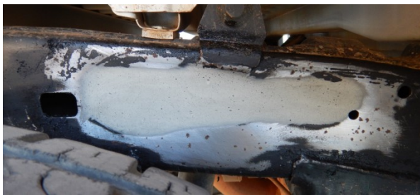
Figura 22 – Região do recobrimento após aplicação de solvente. As marcas de abrasão e a massa plástica denotam a adulteração. Fonte: Autor.
