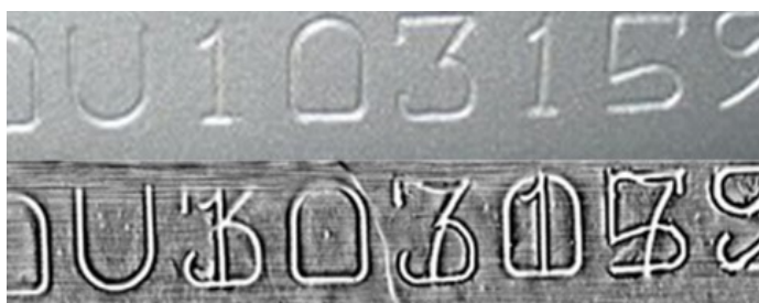
Figura 37 – Revelação pelo dispositivo óptico-magnético. Fonte: Regula Forensics.
