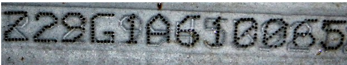
Figura 28 – Em pontos esmaecidos, abaixo da remarcação por pontilhamento (escura), revelação por ataque químico com a utilização do reagente de Fry em gravação primária por agulha. Fonte: Autor.
