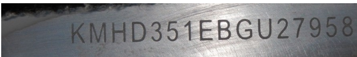
Figura 17 – Região da regravação após aplicação de solvente. Notam-se marcas de abrasão e o espelhamento da superfície, denotando a adulteração. Fonte: Autor.
