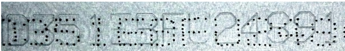
Figura 27 – Em linhas esmaecidas, abaixo da remarcação por pontilhamento (escura), revelação por ataque químico com a utilização do reagente de Fry em gravação primária por scribing . Fonte: Autor.
