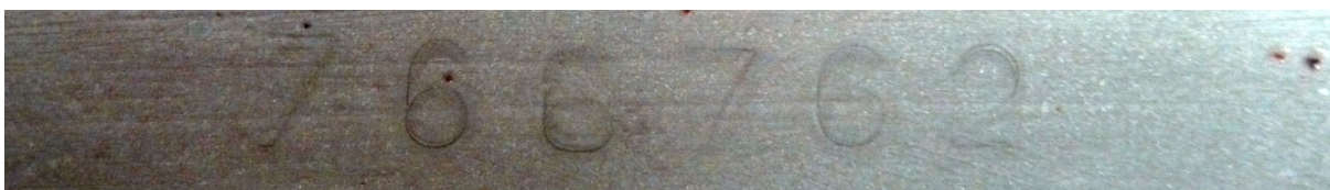
Figura 29 – Revelação por ataque químico com a utilização do reagente de Fry em gravação primária por estampagem. Fonte: Autor.
