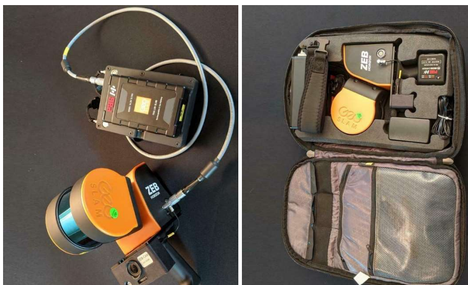
Figura 13 – Equipamento laser scanner completo, com todos os componentes necessários à utilização.
