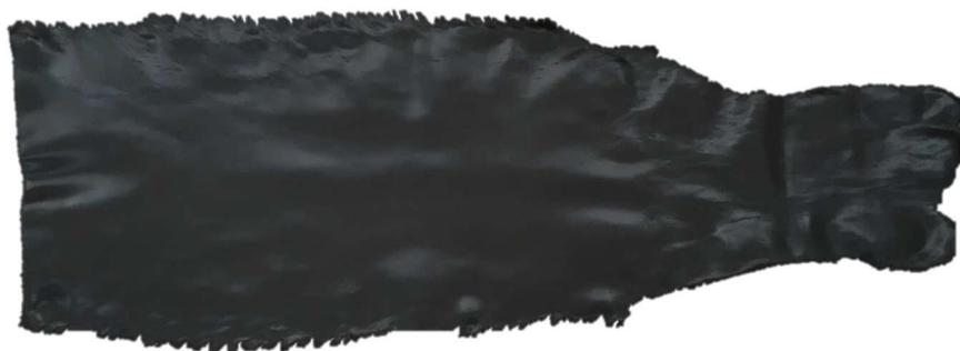
Figura 20 – Laminado de PVC obtido após o processo de calandragem.
