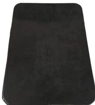
Figura 22 – Placa obtida após processo de prensagem.
