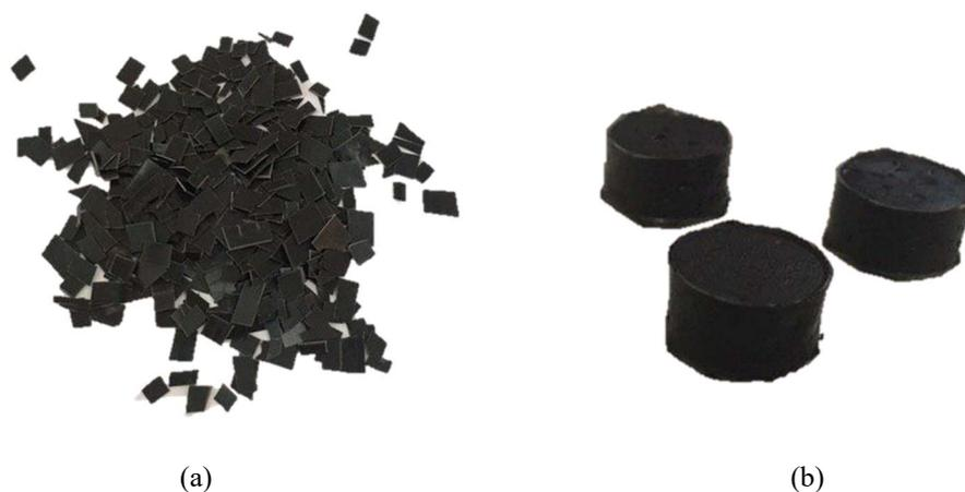
Figura 23 – (a) Material calandrado cortado e (b) cilindros obtidos após processo de prensagem.
