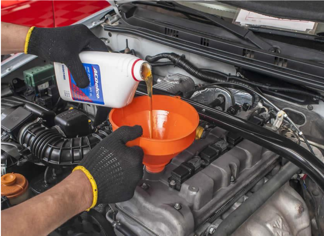
Figura 5 - Troca de fluido lubrificante automotivo, exemplo de manutenção preventiva.
