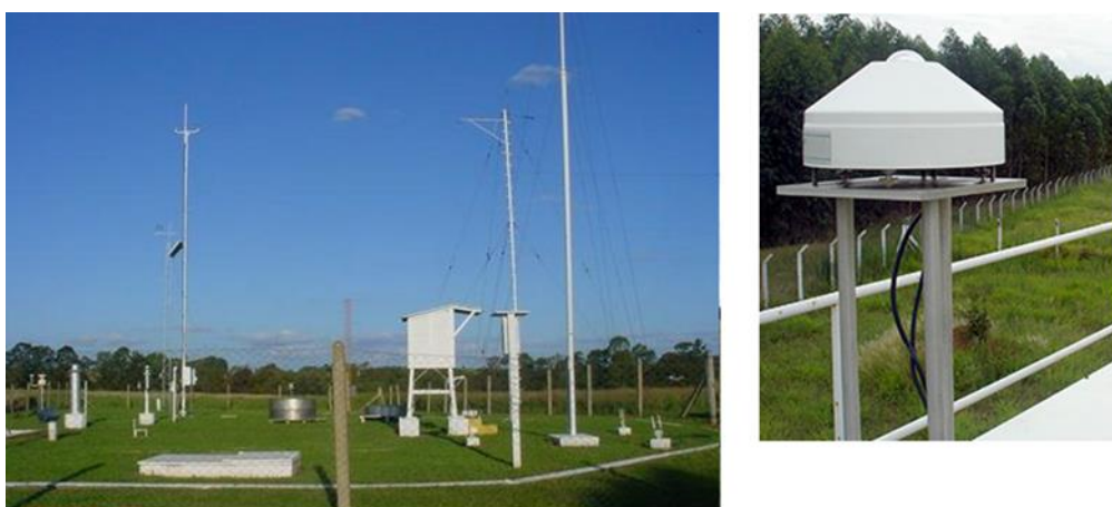
Figura 27 – Detalhe de uma Estação Meteorológica Automática (EMA), mostrando a direita um piranômetro utilizado para medir a GHI
