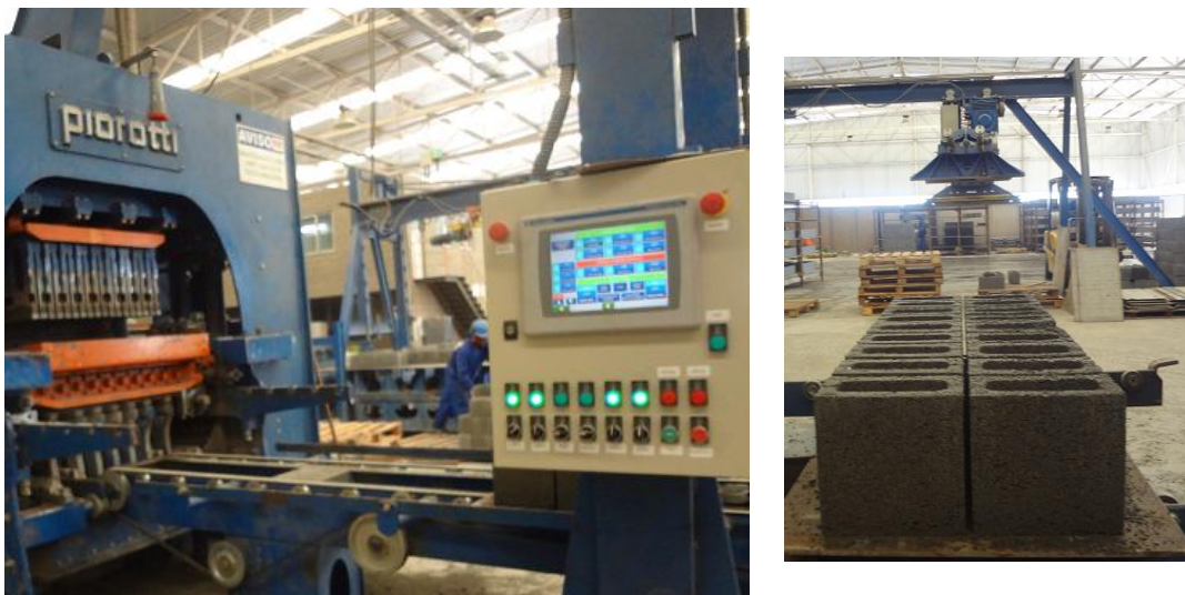
Figura 25 - Moldagem dos blocos
