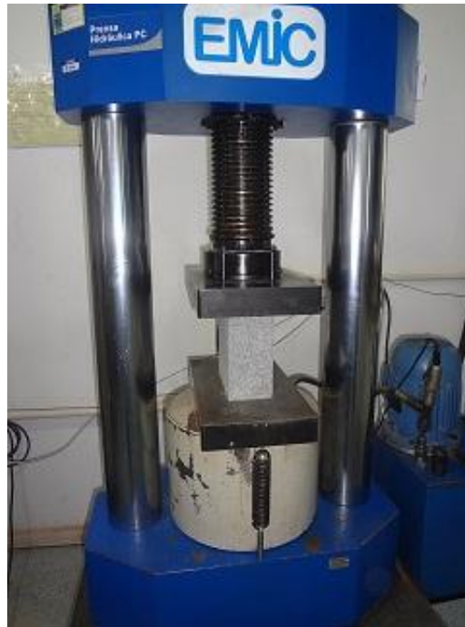
Figura 31 - Bloco na prensa hidráulica
