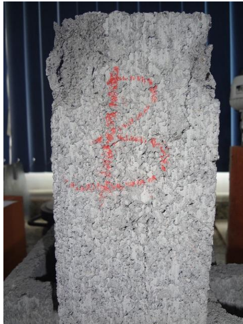
Figura 33 - Bloco da Amostra B após o rompimento.
