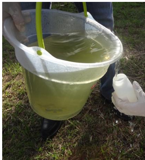
Figura 19 - Amostra do efluente tratado nas lagoas de estabilização: ETE 2
