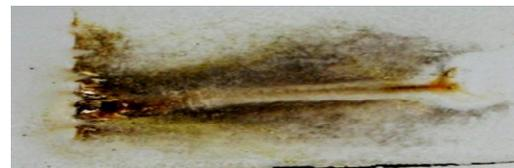
Fig. 4 Trilhamento e erosao no isolador
