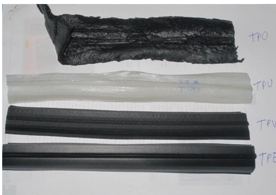
Figura 4. Amostras dos elastômeros TPO, TPU, TPV e TPE estudados para a substituição do EPDM 18
