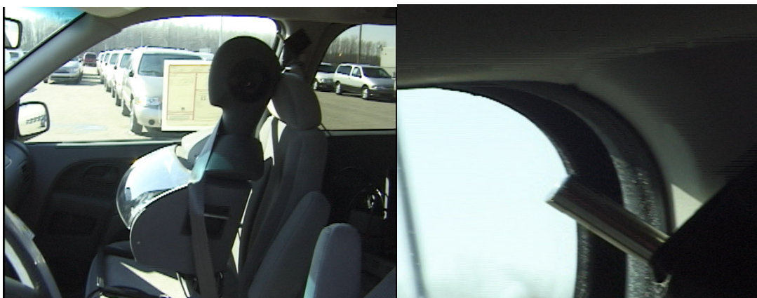
Figura 29- Microfone na região do ruído de vento e em um boneco simulando um passageiro em um veículo.
