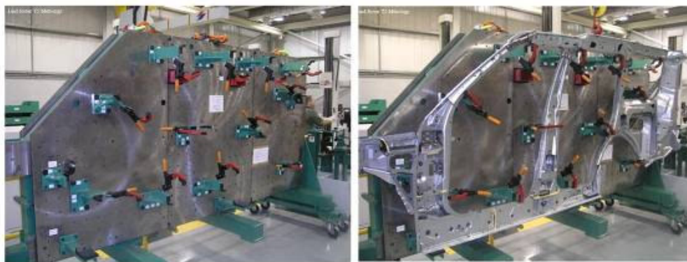
Figura 12- Exemplo de dispositivo de controle
