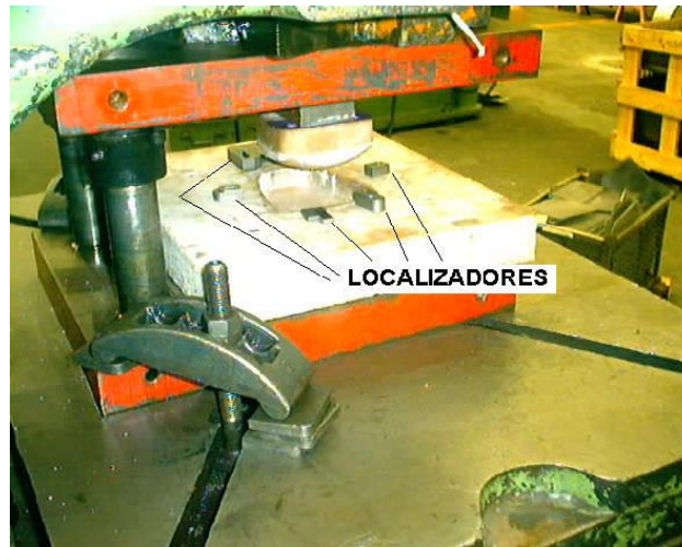
Figura 20- localizador de "blank" em uma ferramenta de estampagem.
