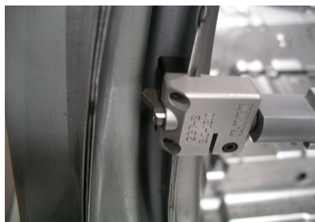
Figura 36. Avaliação dimensional da abertura entre a porta dianteira e a lateral na região da coluna "A"
