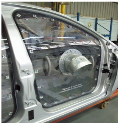
Figura 32. Avaliação de entrada e saída de ar na carroceria.
