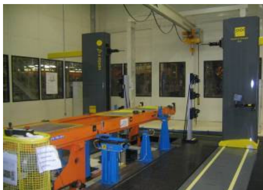
Figura 16- Foto de uma máquina de medição por coordenadas de duas colunas.
